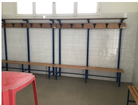
Centro Civico Maiano – gli attaccapanni sono posti ad un'altezza eccessiva per persone in sedia a rotelle o bambini
